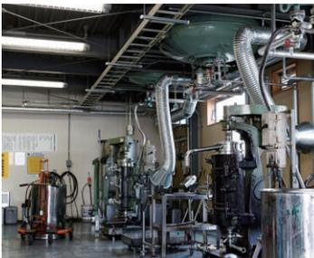
インクの製造ライン。天井にあるタンクで製造し、ドラム缶に詰めます。稼働中は染料が舞い散るので防護服を着用します。
