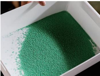
インク溶剤に耐性のあるユリア樹脂がホルダーの原料。砂のような原料を金型に入れ、熱と圧力を加えて形を作ります。
