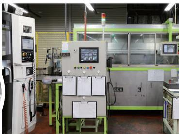
自社開発・製造のサイズ測定機(中央)と、バリ取り機(右奥)。データは自動で切削機械(左)にフィードバックされます。
