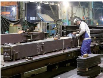
建設機械部品製造の様子。溶接は鉄と鉄を繋ぐ接着剤の役割があります。長い距離はロボットで、細部は人の手で行います。
