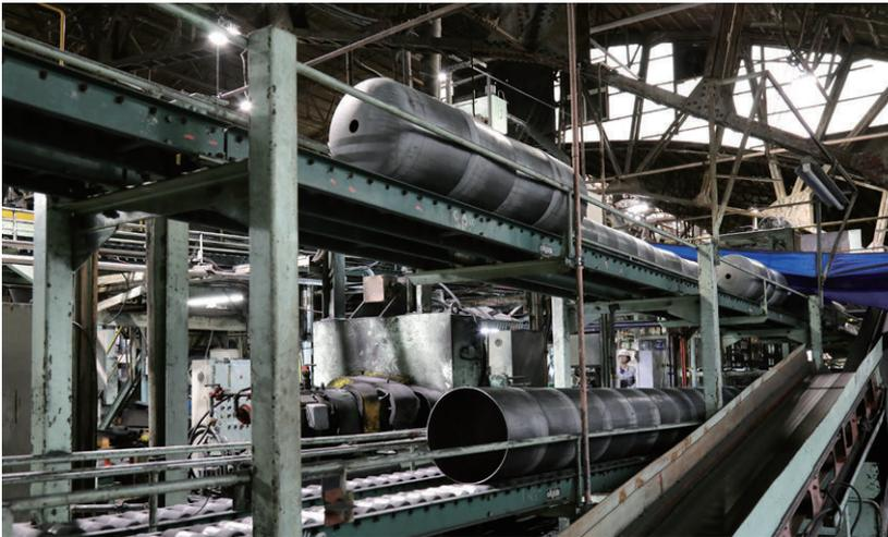
家庭用ガス容器の製造ライン。鋼板を丸切り抜いてお椀型にプレスします。上記大きい穴同士を溶接で繋いで筒型にします。小さい穴のあるほうが上部のパーツです。
