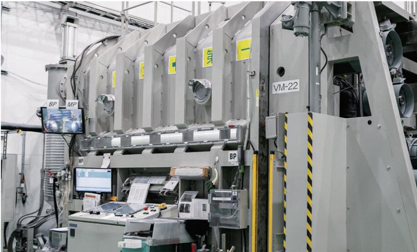
真空状態で加熱する機械、真空蒸着機。
