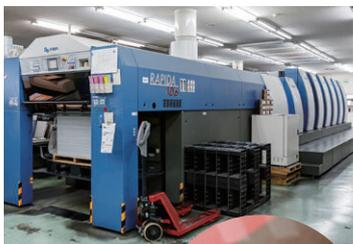
6色刷りオフセット印刷機で、紙に箱のデザインを印刷します。浮き出し表現の表面加工を印刷で行うことも増えています。
