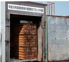
高温乾燥機で乾燥させた木材。水分量を15%程度にして製材します。
