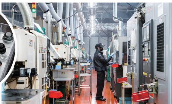
シートベルト部品の製造ライン。鍛造とプレス加工等を鳥取工場で行い、仕上げを倉吉工場で行っています。製造した部品は、多くの国産自動車メーカーで使われています。
