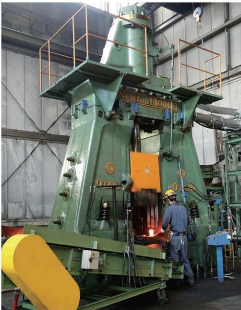
当社の主力設備である3トンハンマー。熱した鉄をたたいて製品にします。足元のペダルでハンマーの強弱を付けながら操作するので、オペレーターの技量が重要。
