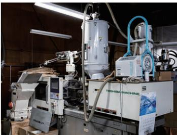
パッキンなどのペン部品を成形するポリエチレン成形機。24時間自動で稼働するよう自社で調整しています。
