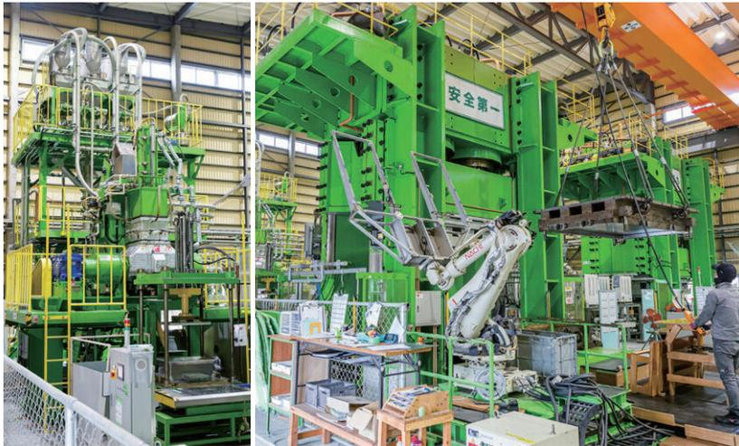
混合熔融機(左)と3,300トンプレス機(右)。200度に熱してやわらかくした原料を、金型の上に乗せてプレスし、板状にします。
