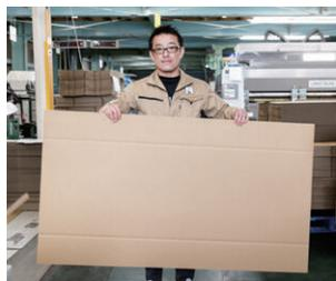
A式段ボール箱の製造は箱の形に切り抜くための抜き型(トムソン型)は不要。あらかじめ折り筋が入った段ボール原紙が仕入れ会社から届きます。
