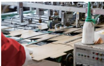
切り抜いた段ボール紙のりしろ部分に機械でのりを塗って貼り合わせ、箱の形にします。
