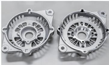
左が研磨前、右が必要な形状に研磨した後。ネジ穴など光っているところが研磨した箇所です。
