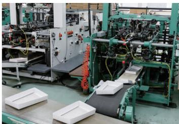
打抜機で箱の形に紙を切り抜いた後は、自動製函(せいかん)機を使って自動的に内側に折り込んでいきます。
