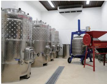
醸造はポンプなどを使わず、できるだけ手動で行います。重力を利用して優しく液体を移動させる「グラビティ・フロー」というワインの製造手法です。
