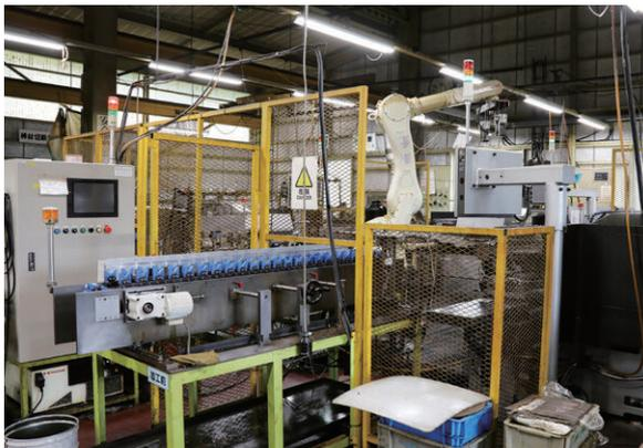
中央のアーム型ロボットを囲むように切削機械とベルトコンベアを配置したなるべく人の手がかからない製造システムは、自社で開発したものです。
