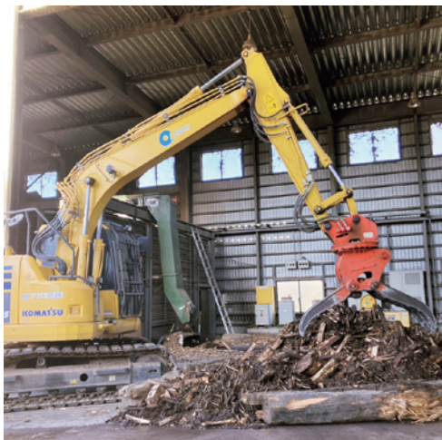
リサイクルセンター 木廃材を専用の機械で木チップにします。 木チップは燃料や木質製品として再利用し、資源の有効活用に取り組んでいます。
