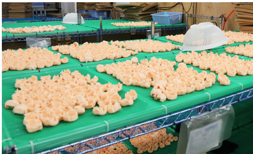
フィギュアの顔パーツ。よごれや傷がないか人の目で検査したあと洗浄し、細部の陰影や顔などをペイント・印刷します。
