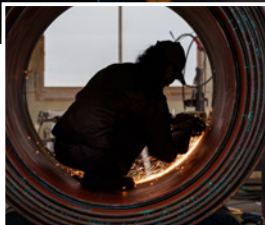
古い基礎を取り除くための機械「杭抜きケーシング」の修理メンテナンスの作業中。
