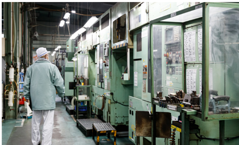
全長約40メートルの切削加工機械。部品の完成まで機械が自動で行います。
