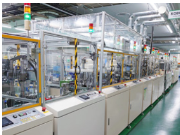
岡山事業所の組立製造現場も倉吉本社に移転。ガスメーター用のスイッチやセンサーを製造するクリーンルームです。
