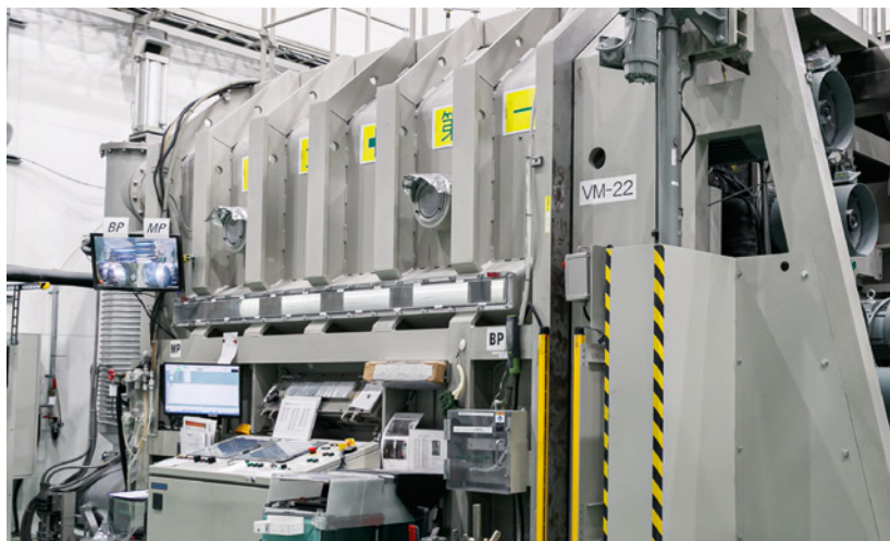
真空状態で加熱する機械、真空蒸着機。 通常は2名のオペレーターで操作・作業しています。
