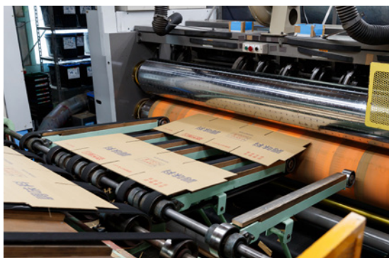
印刷から切り込みまでの作業は一台の機械で行います。のり付け・結束機械へは人の手を借りることなく、自動で送られるように生産ラインが組まれています。
