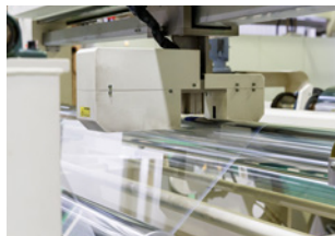
平らな厚みになるよう機械で測定。調整で切った端もリサイクルします。
