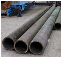
鉄パイプの厚みは20～30mm。両端にジョイントをつけて必要な長さにします。1本5トンになるものもあります。
