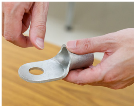
圧着端子の一種。筒状の部分に電線を通して、上から抑えて固定する接続部品です。円状のところはボルトを通す部分。素材は銅でメッキ加工がしてあります。
