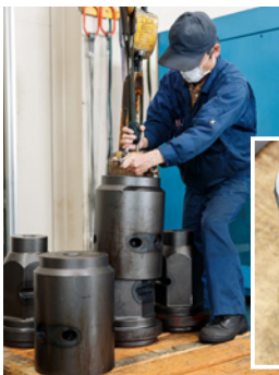
鉄パイプを繋ぐジョイントは倉吉工場で製造。特殊な金属でできたカンナで内側を削って、六角形にします。横からピンを差し込んで動かないようにします。
