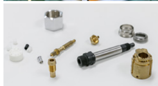
2メートルある金属の棒を、必要な形に削り出して製造します。
