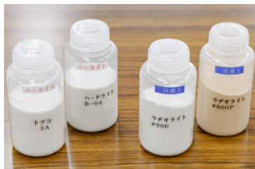
精製したパーライト(左)と珪藻土(右)の粉末。製品は主に粒度で分けられ、使用目的に応じて多数の製品ラインナップの中から選定します。
