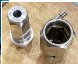
鉄パイプを繋ぐジョイントは倉吉工場で製造。特殊な金属でできたカンナで内側を削って、六角形にします。横からピンを差し込んで動かないようにします。
