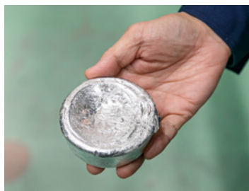
機械の中を真空にした状態でアルミを加熱し、フィルムに吹き付けます。
