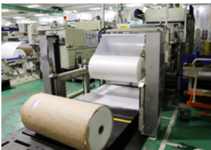
シート状にしたプラスチック材料をヒーターでやわらかくして加工。
