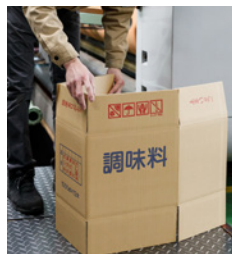
上と下を粘着テープ等で貼り合せて組み立てるみかん箱のような形状を『A式段ボール箱』といいます。
