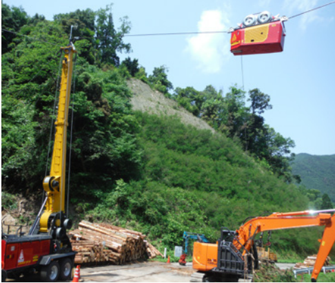
急斜面の現場ではタワーヤード(架線系機械)を使って木材運びます。山では専用の重機を使って作業にあたります。
