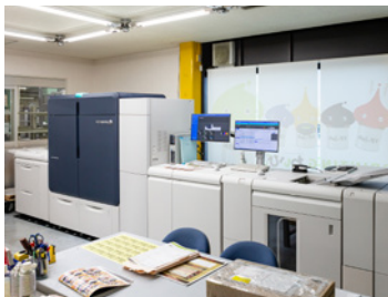
オンデマンド印刷機。オンデマンド印刷はオフセット印刷よりも作業工程が少ないため、小ロットや短納期に対応できます。
