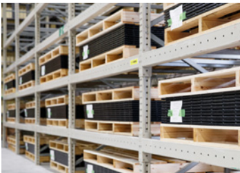
樹脂が完全に固まる時間が必要なので、 プレス後の製品は48時間休ませます。
