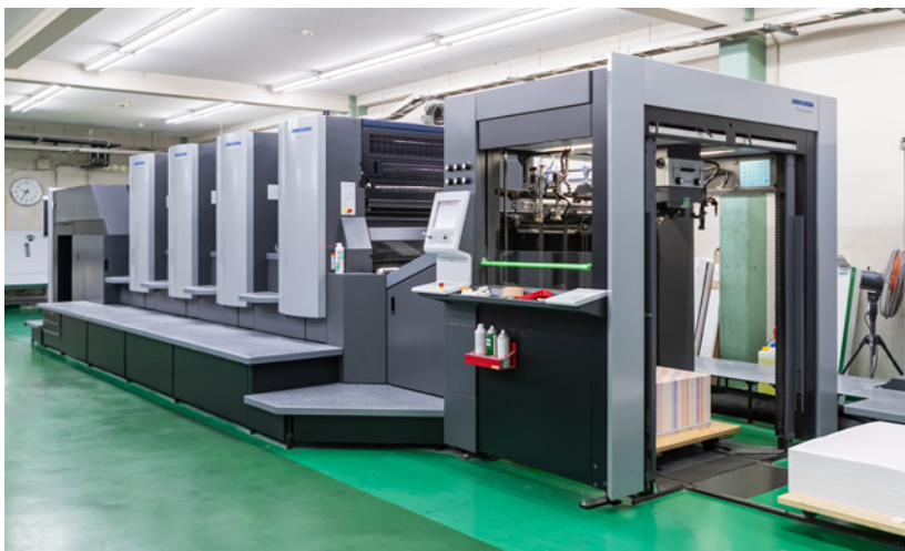
ドイツ・ハイデルベルグ社製のオフセット4色印刷機。チラシやパンフレット・包装紙など、数量が多い印刷物向けの当社の主力機です。
