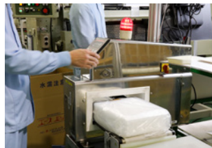
目視検査後、金属探知システムを通して異物を除去し、出荷します。
