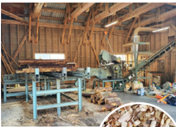
専用機械でチップ材やオガ粉を生産。鳥取県内の企業や農家で使用されています。木材も地産地消のサイクルの一員です。
