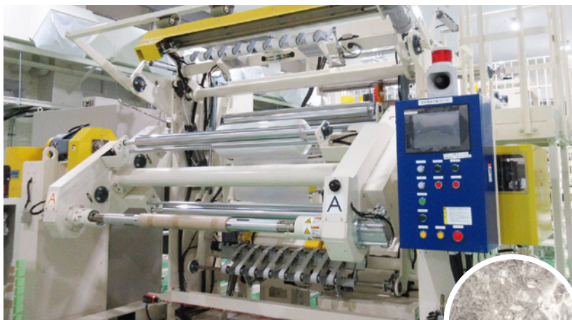
プラスチックシートは樹脂を加熱し、溶かしてシート状に成形します。その後、異物検査を経てロール状に巻き取って完成します。
