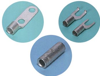
圧着端子の一種。筒状の部分に電線を通して、上から抑えて固定する接続部品です。円状のところはボルトを通す部分。素材は銅でメッキ加工がしてあります。
