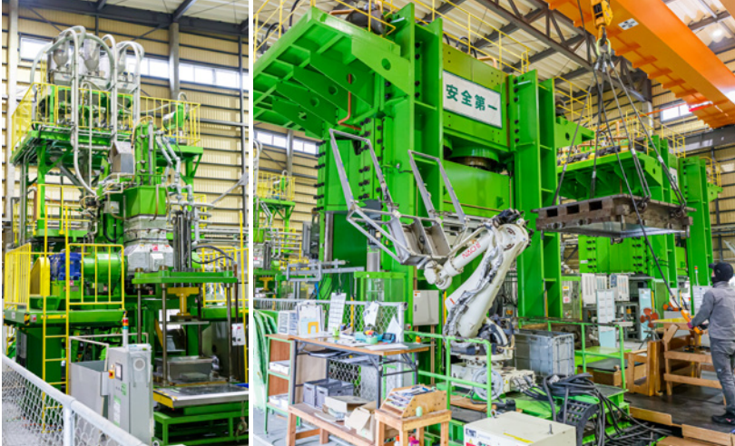
混合熔融機(左)と3,300トンプレス機(右)。 200度に熱してやわらかくした原料を、金型 の上に乘せてプレスし、板状にします。
