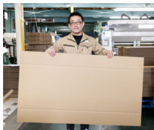
A式段ボール箱の製造は箱の形に切り抜くための抜き型(トムソン型)は不要。あらかじめ折り筋が入った段ボール原紙が仕入れ会社から届きます。
