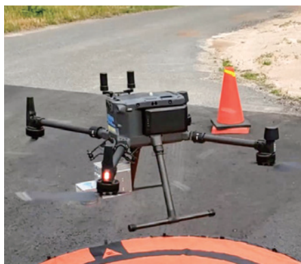
1m×1mの大きなドローン。3D測量に使います。
