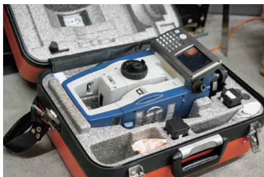
距離と角度が計測できるトータルステーションを使って測量します。
