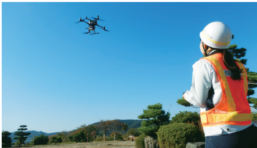
ドローン:MATRICE 300 RTK、搭載レーザー:SCOUT-M2X UAVレーザー測量、空中写真点群測量で短時間に大量の3D点群データを取得します。
