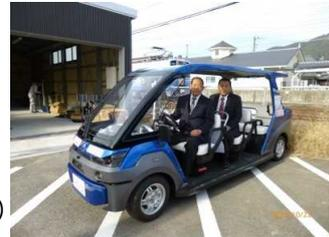
②車は、町道に埋設された電磁誘導線に沿って自動運転走行。 道路幅員3m
