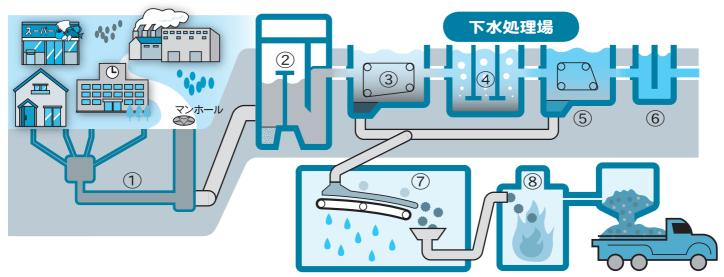
①下水道管 家庭や工場から流された汚水は、下水道管を通って下水処理場に集められます。
