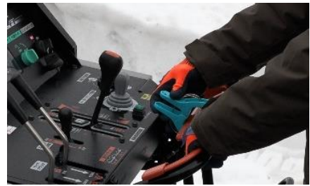
デッドマンクラッチ機構を洗濯 バサミで無効化する様子
