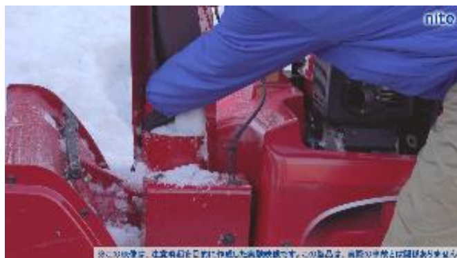
ブロワに直接手を入れて負傷する様子(イメージ)
