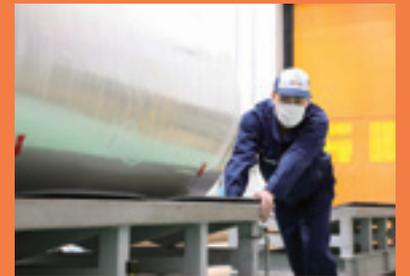
完成した包装材は幅2.3m×高さ1m、重さは2tにもなります。事故にならないよう気を付けて運びます。
