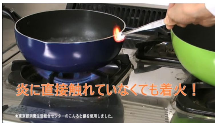
図 3 ガスこんろの火に直接触れていなくても着火する様子
